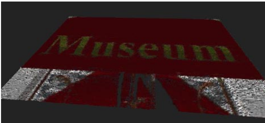
Abbildung A.5: Differenzbild zwischen Orginal-Frame und nach MPEG-Codierung (Video 1)
