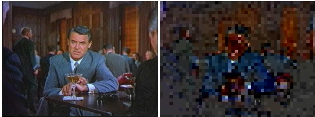
Abbildung 3.4: Blockklassifizierung durch die smooth-block/edge detection -Phase am Beispiel einer Szene aus dem Film "North by North-West" von Alfred Hitchcock
