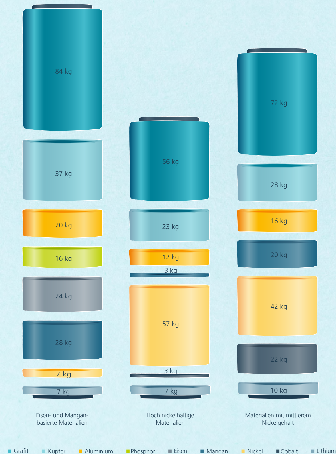
Abbildung 5 Durchschnittliche Rohstoffbedarfe einer Lithium-Ionen-Batterie (Bruttokapazität: 80 kWh) für verschiedene Cluster an Batterie-chemien, in Kilogramm, ohne Bedarfe für Elektrolyte und Binder. [Eigene, gemittelte Berechnung gemäß Fraunhofer ISI eEV Datenbank]
