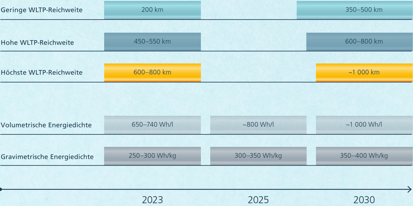
Abbildung 7 Roadmap zu aktuellen und künftigen Reichweiten von Elektrofahrzeugen sowie Entwicklung der Energiedichten von Lithium-Ionen Batterien [12], Anmerkung: WLTP steht für »Worldwide Harmonised Light-Duty Vehicles Test Procedure« und beschreibt ein Testverfahren, um den Verbrauch eines Fahrzeugs zu bestimmen.
