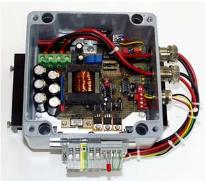
Abb. 1: DC/DC-Wandler zum Anschluss der Brennstoffzelle an die Batterie.
