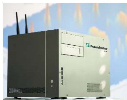
Bild 2: Der Funkmessplatz der Fraunhofer ESK misst die Belegung des Funkspektrums über einen längeren Zeitraum
