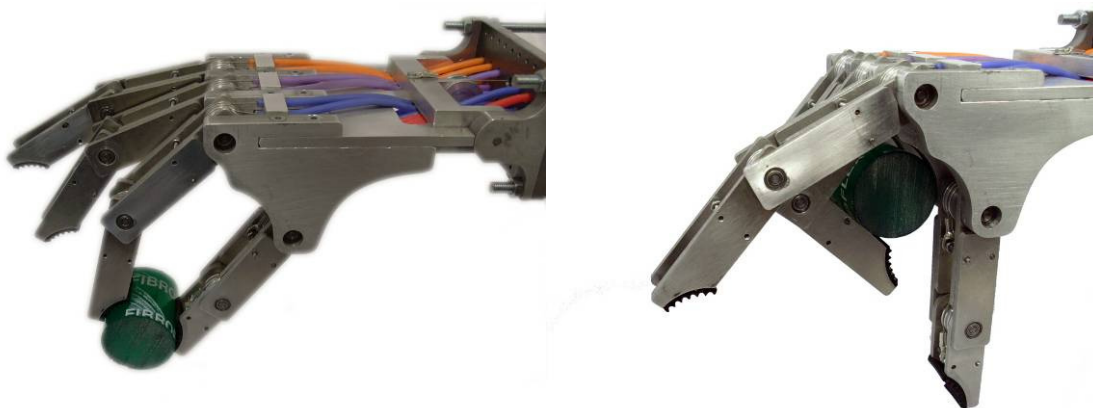
Abb.3: Greifmechanismus, Funktionsmuster, links Pinzettengriff, rechts Zylindergriff [2]
