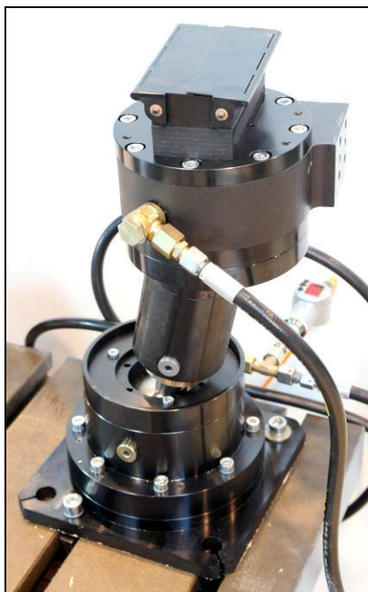
Abb. 2 Adjustable Base Unit (ABU), eine verstellbare Konsoleneinheit speziell für produktflexible Spannvorrichtungen (Erprobungsaufbau bei TKDN)
