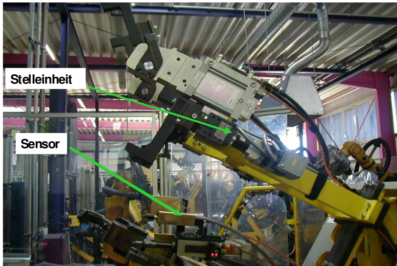
Abb. 4 Linear Base Unit (LBU), Stelleinheit für die Bauteilauflage (Einsatz in der Produktion von B-Säulen-Verstärkungen)
