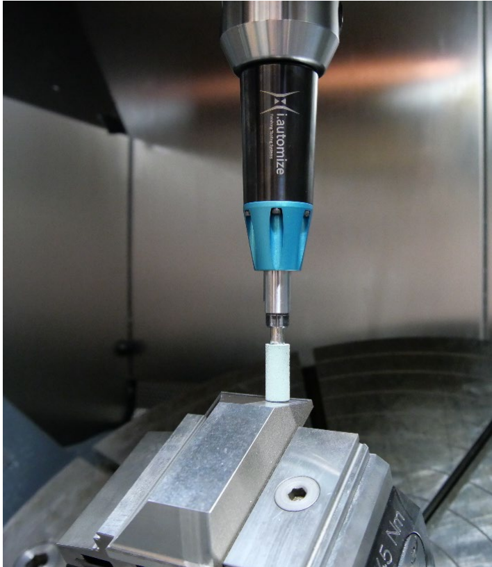
Maschinenintegrierte Feinbearbeitung von additiv gefertigten Bauteilen mit nachgiebigen, kraftgeregelt Werkzeugen [Fraunhofer IPT, Hi.automize]
