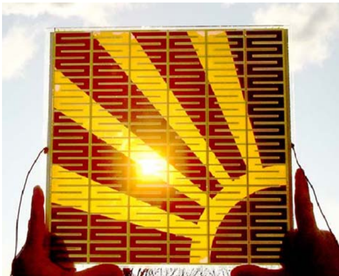
Abbildung 4-33: Prototyp einer Farbstoffsolarzelle
