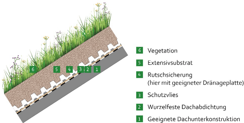
Abbildung 6: Schichtaufbau Schrägdachbegrünung bei 10 – 45° Dachneigung (Quelle: BuGG)
