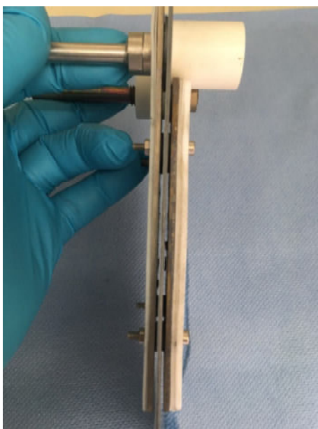
Abbildung 17: Elektrodenstack mit dazwischenliegendem Separator (Celgard 3501) und Separatorhalter
