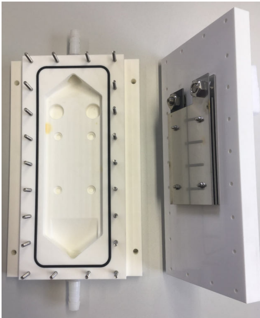
Abbildung 12: Von der Firma DiaCCon GmbH erworbene Abwasserelektrolysezelle mit teilbarem PP-Gehäuse, 2 Edelstahlkathoden und einer BDD-Diamantelektrode
