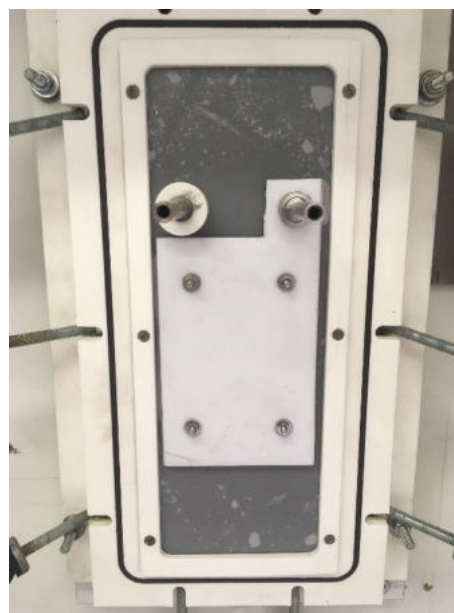
Abbildung 18: Eingebauter Elektrodenstack in die neu entwickelte, geteilte Abwasserelektrolysezelle
