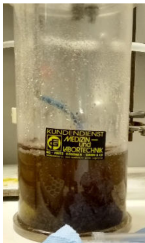
Abbildung 76: Verunreinigte Ammoniumsulfatlösung durch Organikverschleppung aus der unbehandelten wässrigen Phase bei der Ammoniakstrippung
