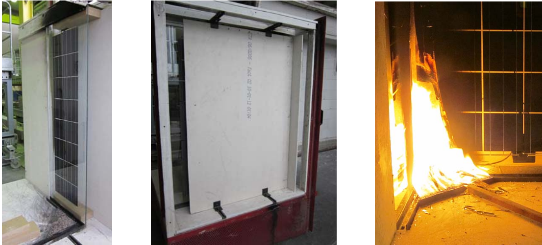
Abbildung 6: Module im SBI-Test (Single-Burnig-Item-Test) nach EN ISO 13823. Klärungsbedarf besteht bei den Ausführungsdetails.
