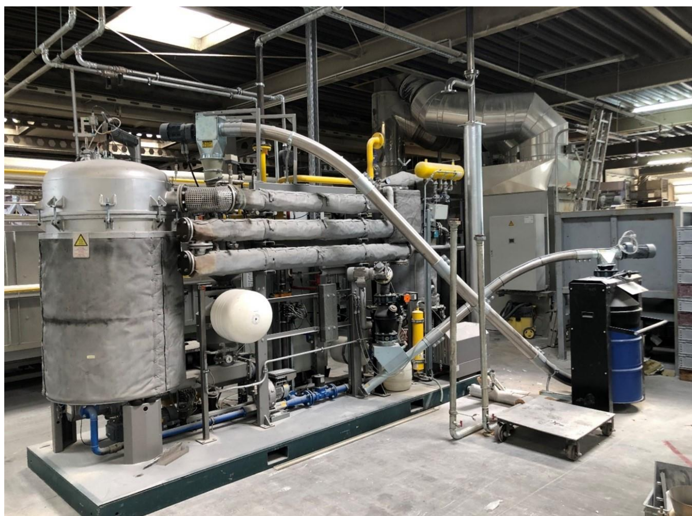
Im Projekt KliSchGa2 aufgestellter und erfolgreich an den Schnellbrandofen integrierter Holzvergaser der Firma Burkhardt bei Rösler CeramInno.
