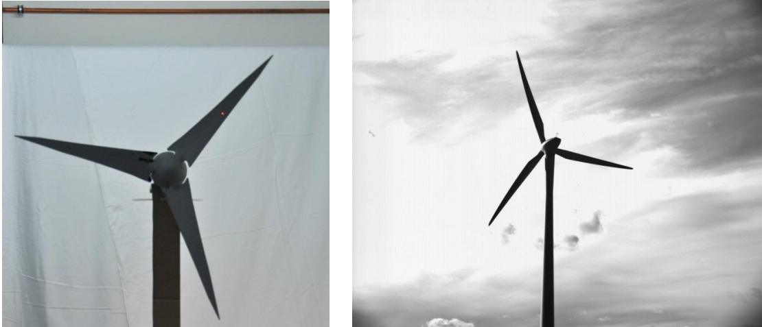
Abbildung 2.37: links: Aufnahme des WEA-Modells im Labor mit optischer, visueller Kamera; rechts: Aufnahme einer WEA mit der SWIR-Kamera.
