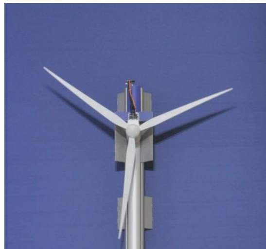
Abbildung 2.43: Detailansichten des in Abbildung 2.42 gezeigten Messestandes; links: Lasermesssystem mit Schwenk-Neigeeinheit und feststehender Tracking-Kamera; rechts: Rotor des WEA-Modells mit Elektroantrieb sowie mit Miniaturlautsprechern in den Blättern zur Schwingungsanregung.
