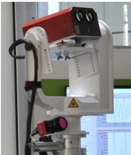
Abbildung 2.43: Detailansichten des in Abbildung 2.42 gezeigten Messestandes; links: Lasermesssystem mit Schwenk-Neigeeinheit und feststehender Tracking-Kamera; rechts: Rotor des WEA-Modells mit Elektroantrieb sowie mit Miniaturlautsprechern in den Blättern zur Schwingungsanregung.
