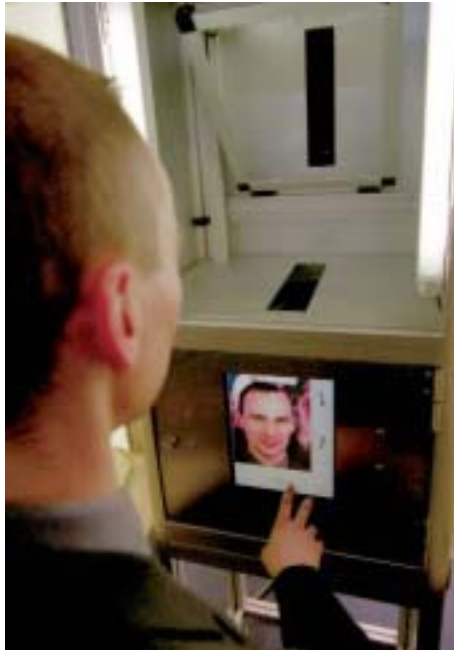
Der 3D-Gesichtsscanner erlaubt eine zuverlässige Identifizierung von Personen
