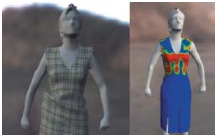
Abbildung 2: Links: Interaktion mittels Stecknadeln. Rechts: Visualisierung von Spannungen im Material
