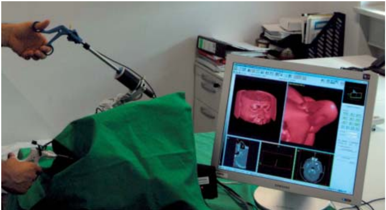
Aufbau eines Operationssimulators mit einem haptischen Rückkopplungs-System
