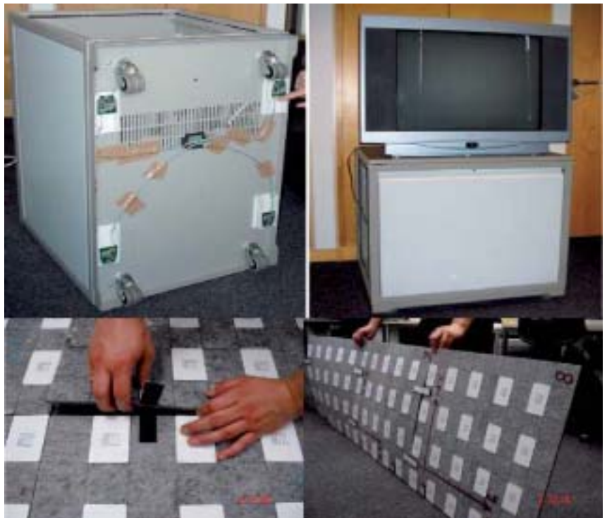
RFID-basiertes System zur Orientierung und Positionierung mobiler Multimedia-Geräte: Auf dem Fußboden werden RFID-Sendern ausgelegt. Die am Gerät angebrachten Empfänger sind dadurch in der Lage, ihre eigene Position und Richtung zu bestimmen
