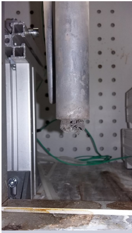
Abbildung 7-4 Tauchrohr mit geschmolzenem PET nach öffnen des erkalteten Reaktors
