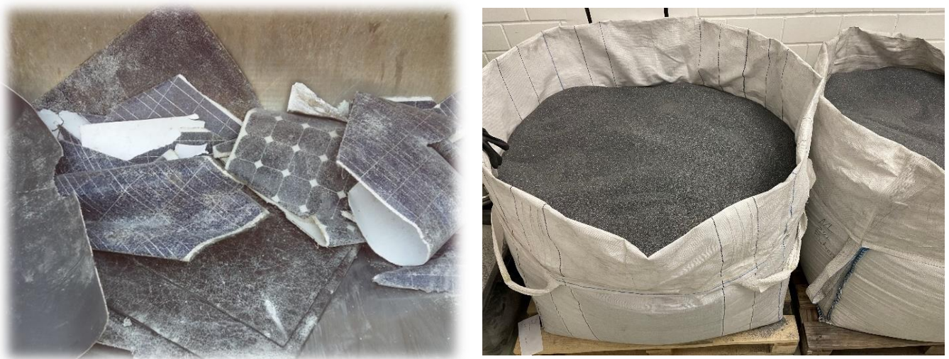
Abb. 13: Links: Altmodule unterschiedlicher Herkunft. Rechts am Fraunhofer CSP zurückgewonnene Zellfragmente.
