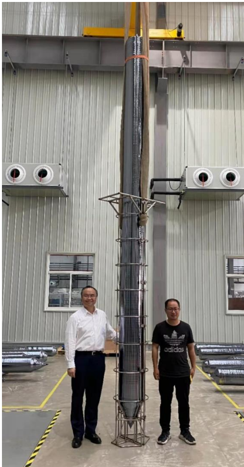
Abb.7: Monokristall mit 5 m Länge, hergestellt von der Firma Kayex-Linton (China) [16].
