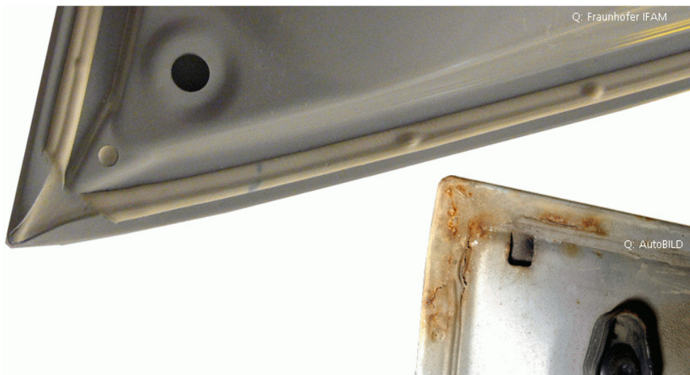
Fehlerstellen in der Nahtabdichtung und Korrosion als Folge
