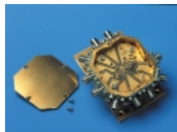
4:1-Multiplexer für die optische Datenübertragung bei 40 Gbit/s.
