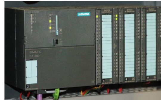
Heute: SPS als Automatisierungskomponente, Beispiel: Siemens SIMATIC S7
