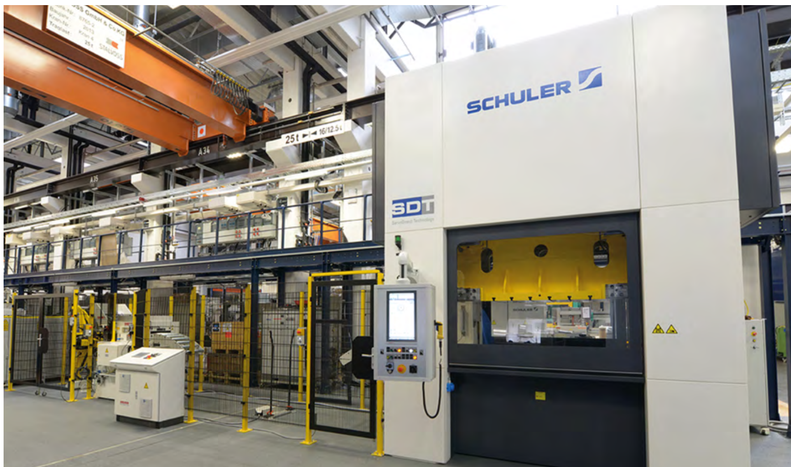
Figura 3: Linea di presse servoassistite presso il Fraunhofer IPT per prove orientate all'industria dei processi di lavorazione della lamiera.
