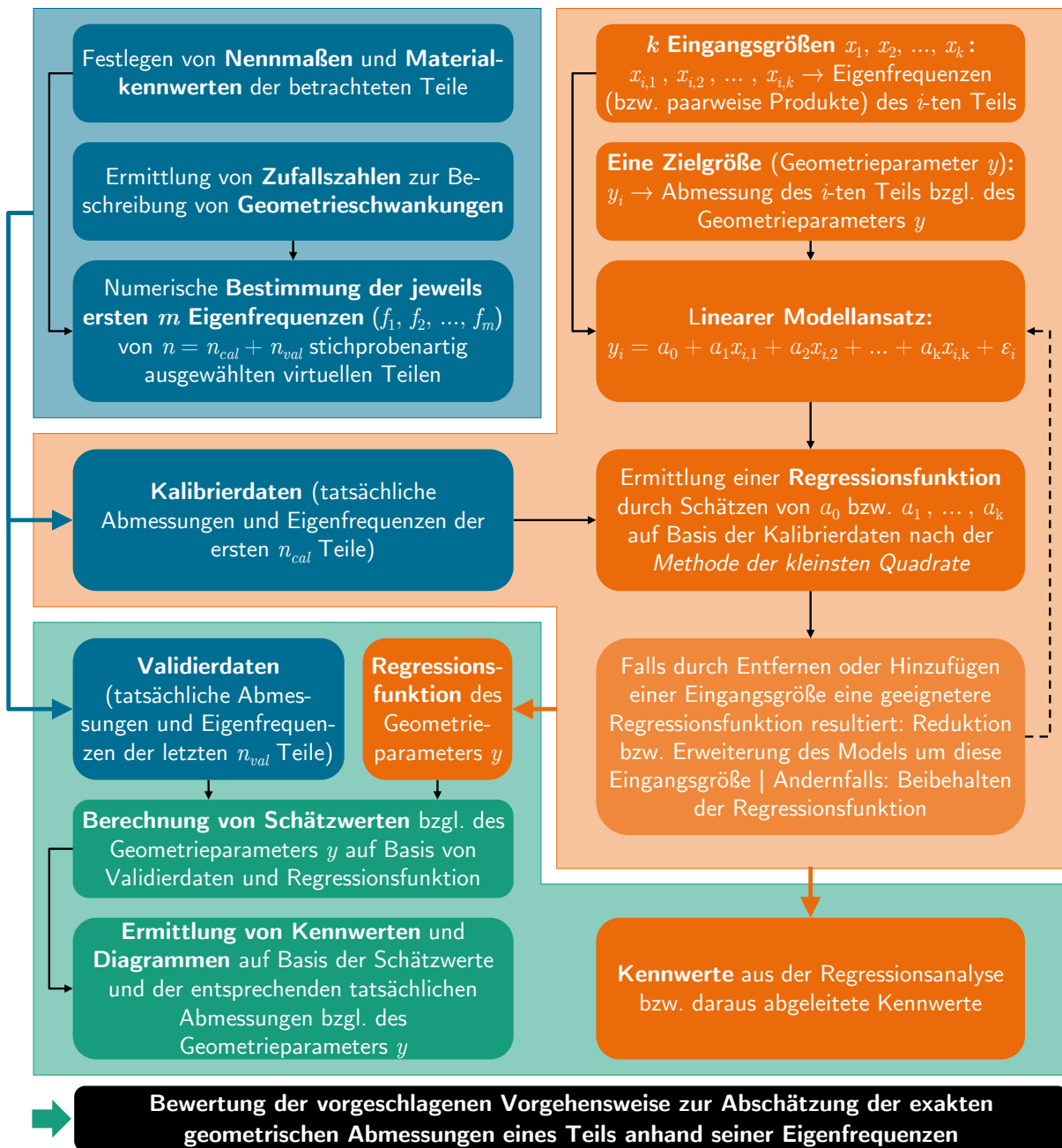
Abbildung 4.2: Detaillierte schematische Darstellung der geplanten Vorgehensweise mit den Arbeitsschritten Generierung von Daten (blau), Kalibrierung (orange) und Validierung (grün)
