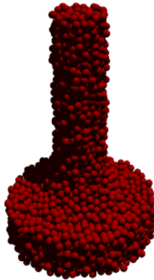
Abbildung 4.7: Querschnitt einer Zugprobe
