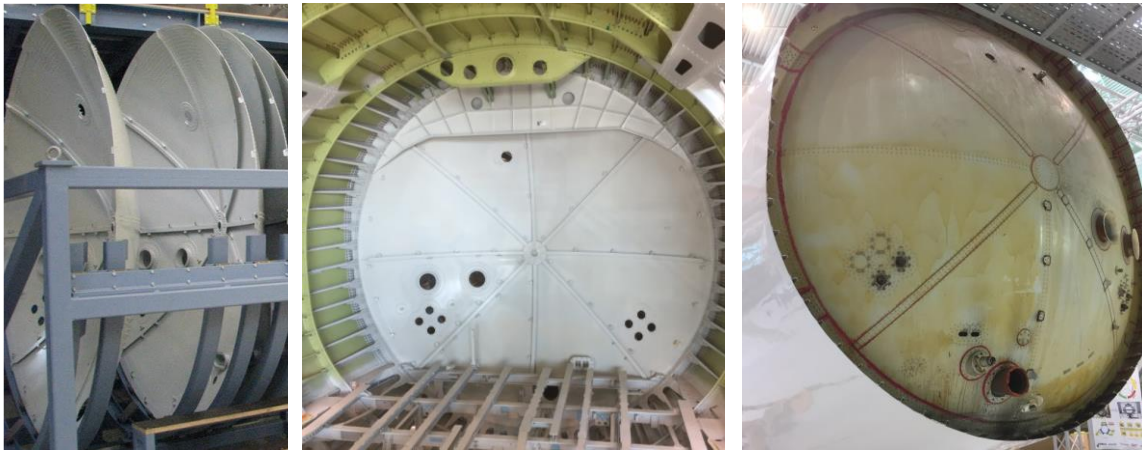
Abbildung 6-6 Zusammengebaute hintere Druckschotts eines Airbus A320 (links), im Flugzeug montiertes hinteres Druckschott [Sch19] (Mitte und rechts)
