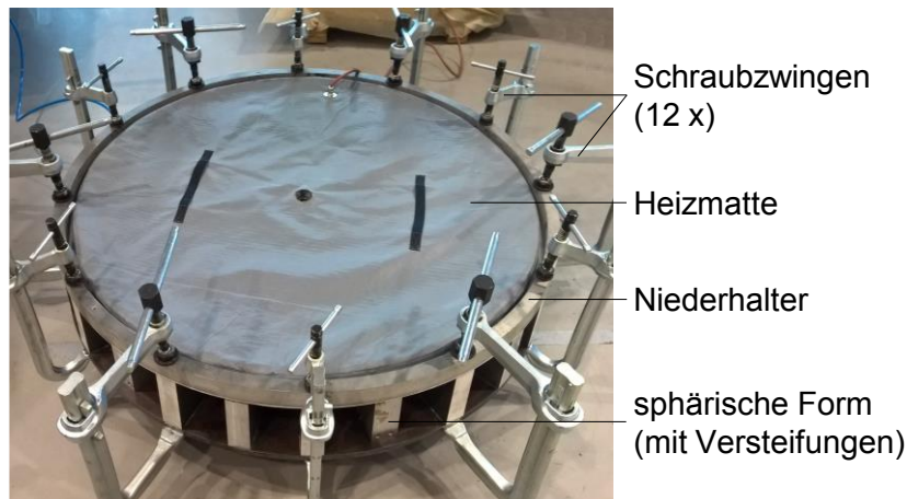
Abbildung 5-28 Versuchsvorrichtung zum pneumatischen Umformen sphärischer Blechbauteile mit Niederhalter und Heizmatte (Blechrunde wird in der Darstellung durch Heizmatte verdeckt)
