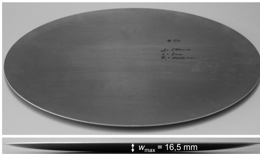
Abbildung 5-8 Versuchsergebnis (Endausformung) des niederhalterlosen pneumatischen Tiefziehens einer Blechrunde mit beulunterkritischem Durchmesser (AlMg4,5Mn, d = 560\text{ mm} , R = 1.000\text{ mm} , s = 2,0\text{ mm} )
