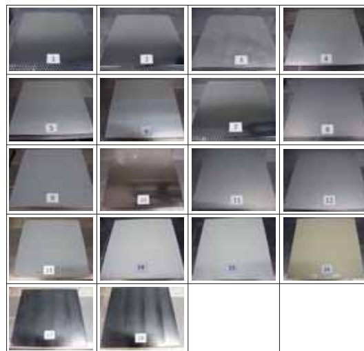
Abb. 1: Bilder der untersuchten Materialoberflächen: 1 bis 3: Edelstahl; 4 bis 13 Aluminium; 14 bis 15 PET-P in weiß, 16: Elastomer SBR 67 und 17 bis 18 PET-P in schwarz (Quelle alle: Fraunhofer IPA).
