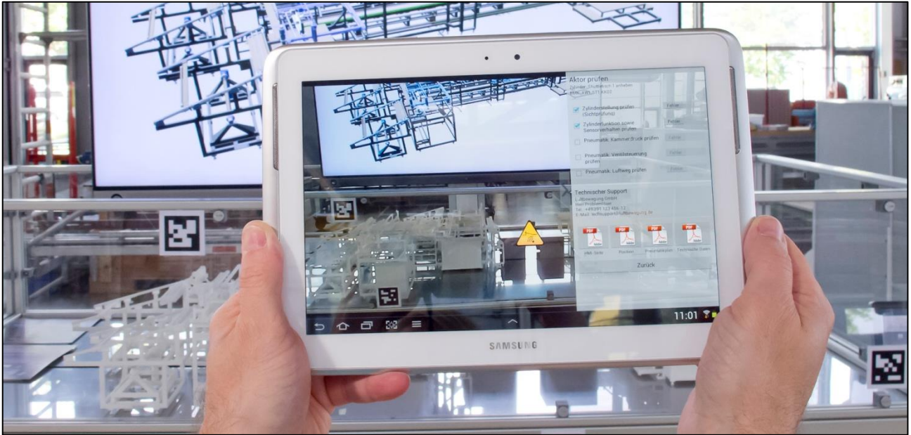
Abbildung 2: Tablet als HMI zur Fehlerlokalisierung und Problemlösung; Fehlerauslösende Komponente durch Augmented Reality lagesynchron mit gelbem Icon markiert; Anleitung zur Problemlösung rechts Foto: Daniela Martin / Fraunhofer IFF
