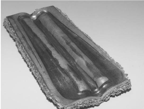
**Bild 2:** Geschmiedete Verbundplatte (Aluminium-Schaumkern/-Deckbleche)
