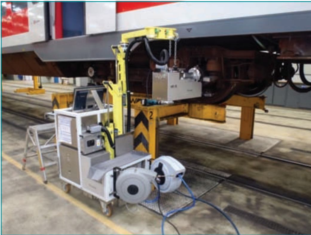
Abb. 2: HPS Ultraschallprüfeinrichtung für Radsatzwellen mit Längsbohrung
