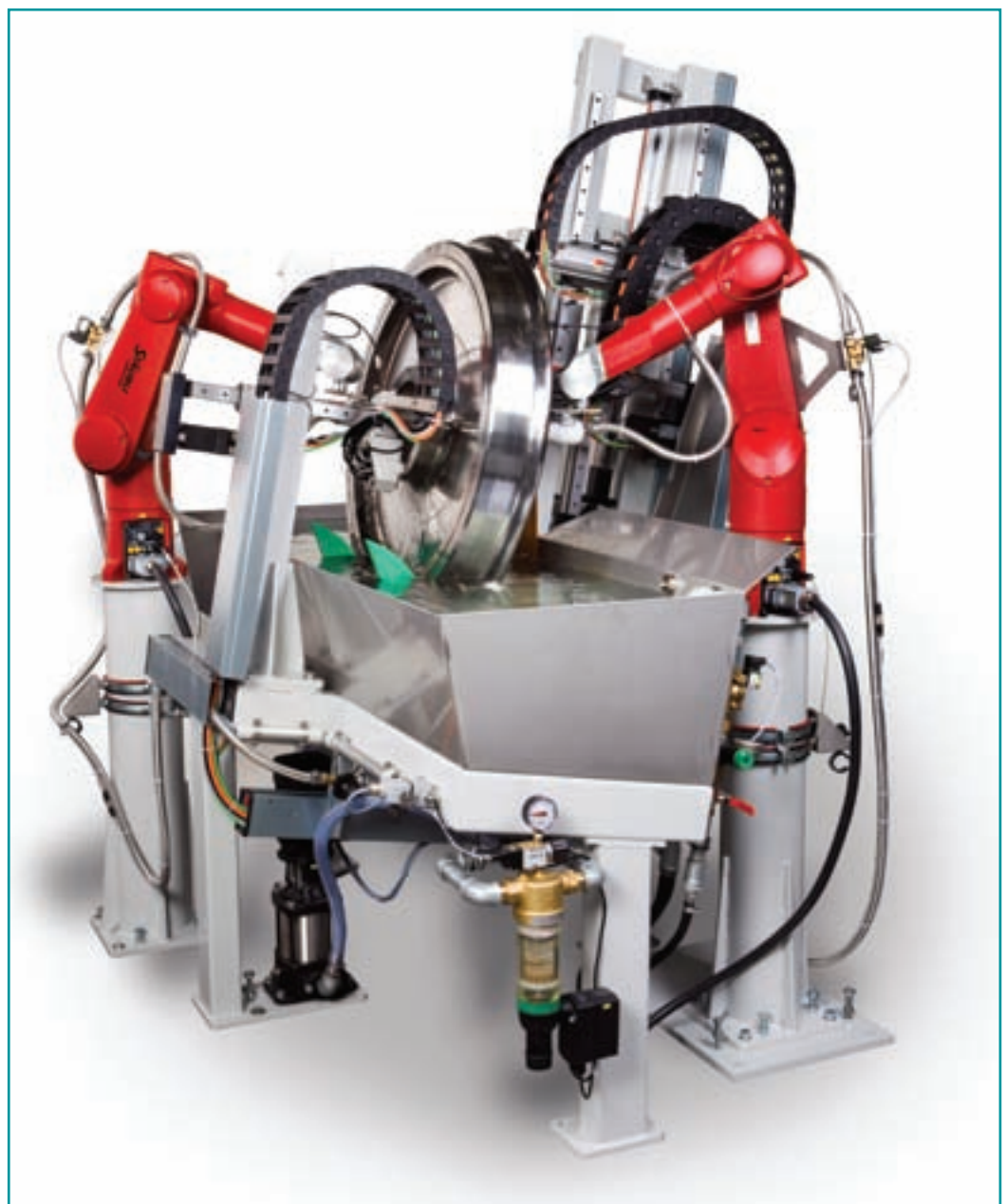
Abb. 1: RWI Prüfsystem für Neuräder
