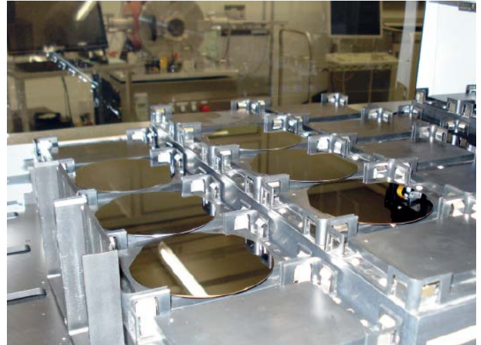
Abb. 5: Ausgelegte Silizium-Wafer zur Messung sedimentierter Partikel in einem Hamilton Microlab Star. © Fraunhofer IPA
