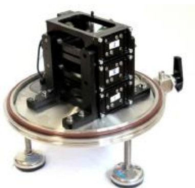
Abb. 9: Das NIR Laserspektrometer besteht aus drei White-Zellen für die Gase O 2 , CO und HCL. Diese Gase haben aufgrund ihrer sehr unterschiedlichen Linienstärke deutlich unterschiedliche Nachweisempfindlichkeiten. Das NEC ist durch Messungen in der White-Zelle mit 2 m optischen Weg bei 1000 mbar und Raumtemperatur bestimmt worden.
