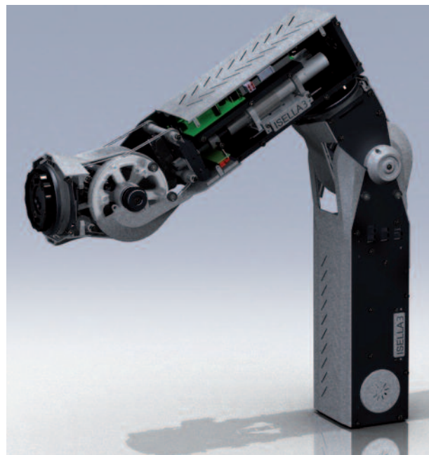
Bild 3 Optimierter Arm aus zwei ISELLA-3-Modulen
