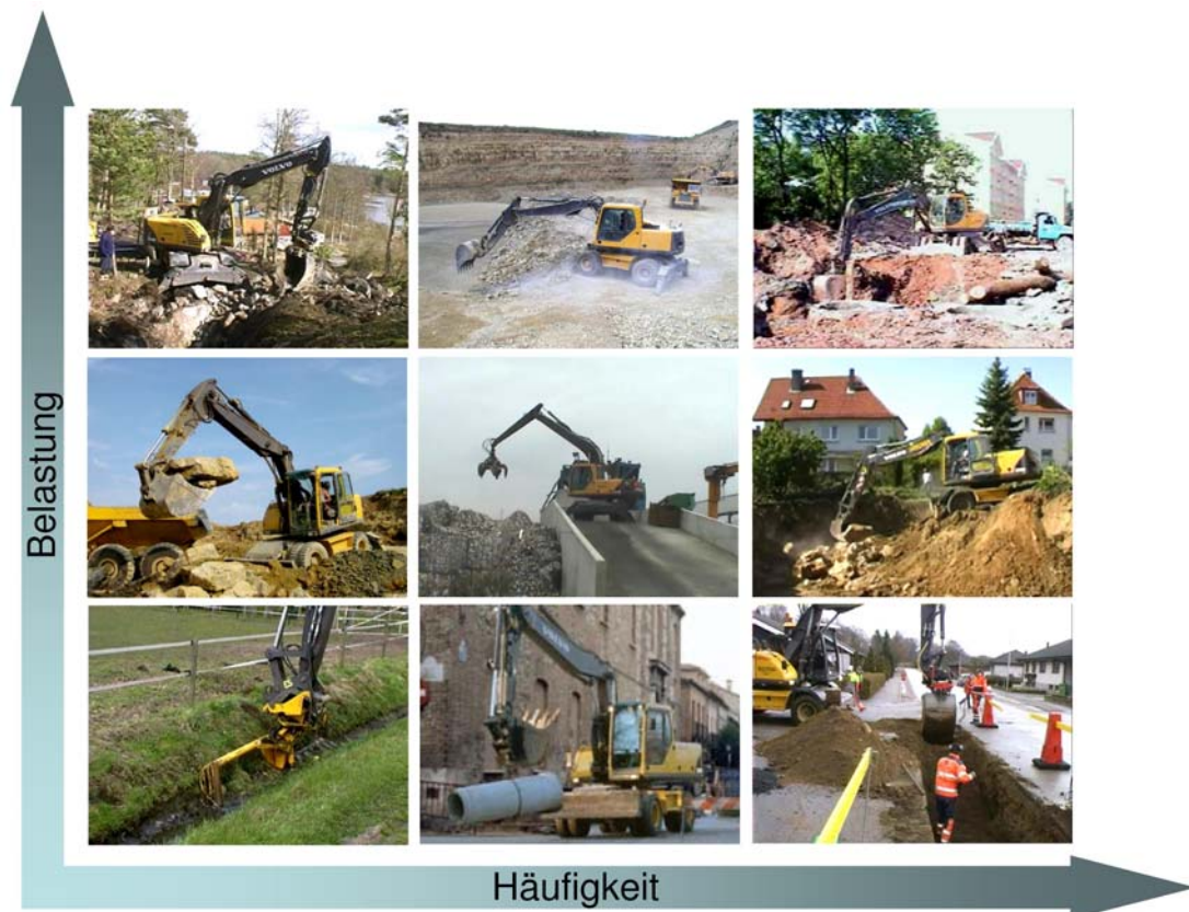
Bild 1: Beispiele für Anwendungen eines Mobilbaggers, die sich in Ihrer Häufigkeit und ihren Belastungen deutlich unterscheiden.
