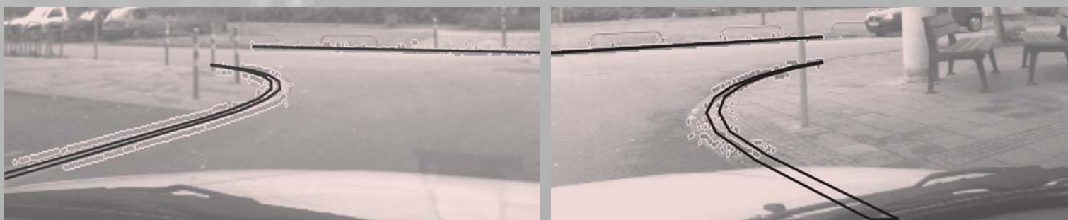
Ausschnitt einer Kreuzung, wie sie vom Computersystem „gesehen“ wird. Die schwarzen Linien deuten die erkannten Bordsteine an. Anhand dieser Linien kann das Computersystem das Fahrzeug um die Kurve lenken.
