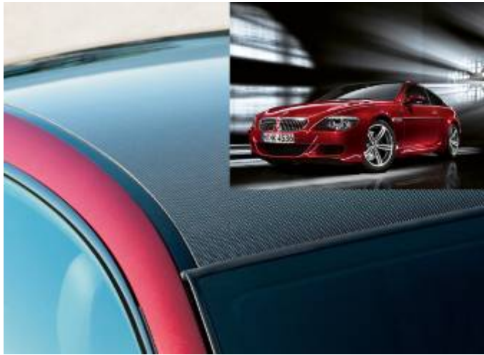
CFK Dachsegment BMW M6 Geklebt [1]
