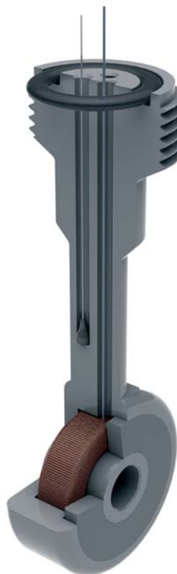
Abb. 8: 3D-Modell des Messkopfprototyps (Teilschnitt) mit Ringkern und Temperaturfühler
