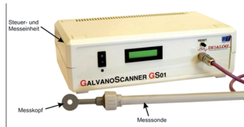
Abb. 6: Messsonde, Messkopf, Steuer- und Messeinheit vom GalvanoScanner GS01
