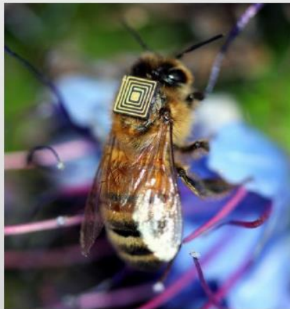
Biene mit RFID-Label [Quelle: heise.de ]
