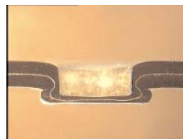
Schliffbilder: Clinchen von Stahl (H320) ohne LUS (Bild links) und mit LUS
