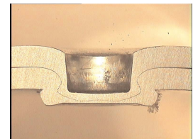
Schliffbilder: Clinchen von Aluminium (Ecodal) ohne LUS (Bild links) und mit LUS (Bild rechts)
