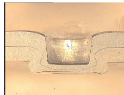
Schliffbilder: Clinchen von Aluminium (Ecodal) ohne LUS (Bild links) und mit LUS (Bild rechts)
