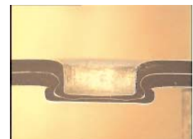
Schliffbilder: Clinchen von Stahl (H320) ohne LUS (Bild links) und mit LUS
