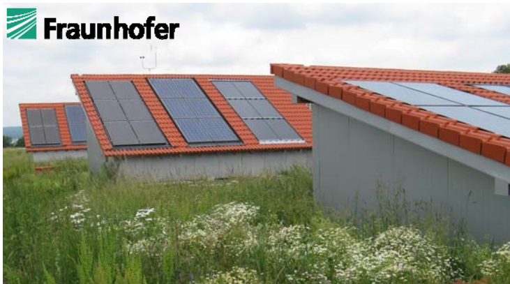
Abbildung 1: Musterdächer auf dem IWES-SysTec Gelände mit 15^\circ , 30^\circ und 45^\circ Dachneigung (von links nach rechts) und Freifeldaufstellung mit und ohne Dämmung.
