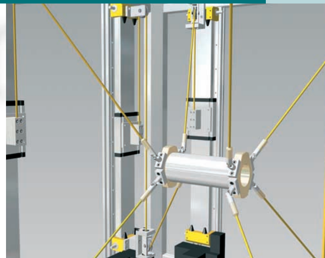
Bild 1: Arbeitsplattform der Seilkinematik
