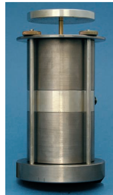
◀ Prototyp eines Positioniersystems mit adaptiver magnetofluidischer Dämpfung in beide Richtungen
