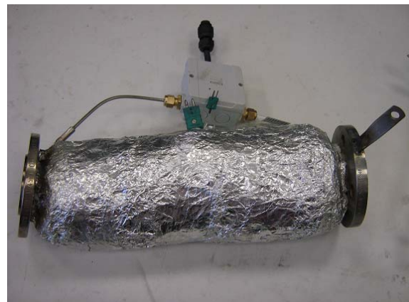
Abbildung 15: technische Zeichnung (Ausschnitt) des Verdampfers in Einbaulage sowie Ansicht mit Beheizung und Isolierung
