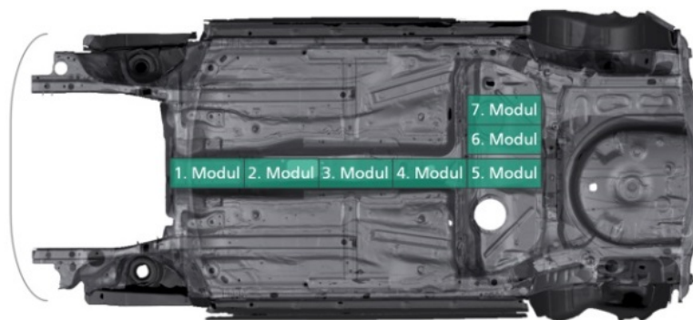
Abbildung 11: Anordnung der Batteriemodule, Karosserieunterboden
