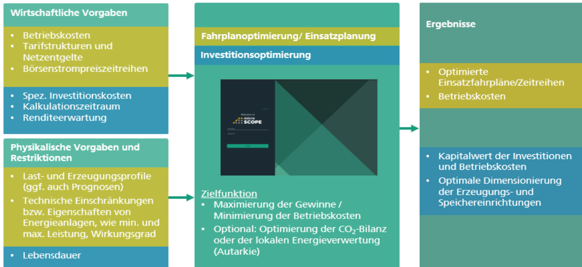
Abbildung 5: Inputs und Ergebnisse der Optimierungstools microSCOPE und investSCOPE des Fraunhofer IEE. Hellgrüne Felder kennzeichnen die Investitionsoptimierung und blaue die Einsatzoptimierung. Quelle: [101]
