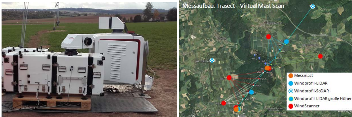
LiDAR-Scanner (links) und Messaufbau mehrere Multi-LiDAR-Systeme im Kassel-Experiment des Europäischen Vorhabens Neuer Europäischer Windatlas NEWA [Quelle: Fraunhofer IWES, Kassel]
