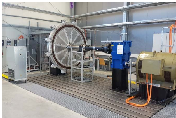
Magnetring-Generator im Labormaßstab (176 kW) [Quelle: Fraunhofer IWES, Kassel]
