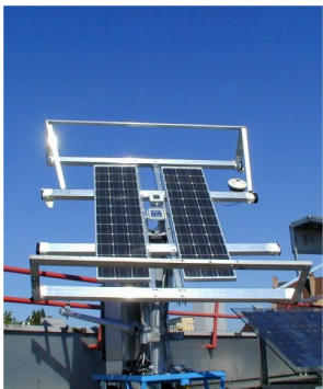
Abb. 2: Testaufbau zur Untersuchung von Einstrahlungs- und Temperaturverhalten von PV Modulen nach dem Norm Entwurf IEC 82/254/NP. Links: PV Module montiert auf einem 2-achsigen Nachführsystem. Rechts: Gitter zur Regulierung der Einstrahlungsintensität.
